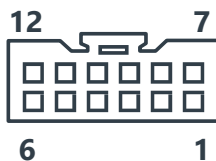
Рис. 1 Нумерация контактов в разъемах, вид со стороны проводов
